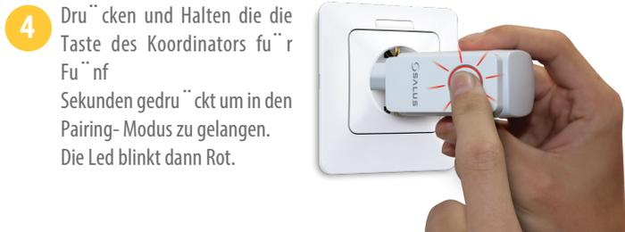
**3** Drücken und Halten die die Taste des Koordinators für fünf Sekunden gedrückt um in den Pairing-Modus zu gelangen. Die Led blinkt dann Rot.
