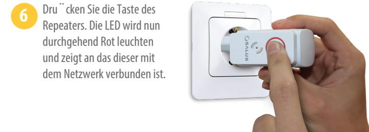
**5** Drücken Sie die Taste des Repeaters. Die LED wird nun durchgehend Rot leuchten und zeigt an das dieser mit dem Netzwerk verbunden ist.
