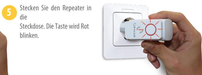
**4** Stecken Sie den Repeater in die Steckdose. Die Taste wird Rot blinken.
